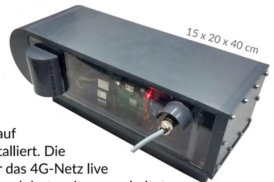
Die Messzellen werden auf dem Dach der Busse installiert. Die Messungen werden über das 4G-Netz live ins Internet übertragen, und dort weiter verarbeitet.
