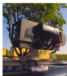
Um eine Momentaufnahme einer Stadt zu erstellen kann eine Messzelle auf einem Fahrzeug montiert werden. So hat AirVeraCity am 5. Juni 2019 Messungen in Augsburg durchgeführt.
